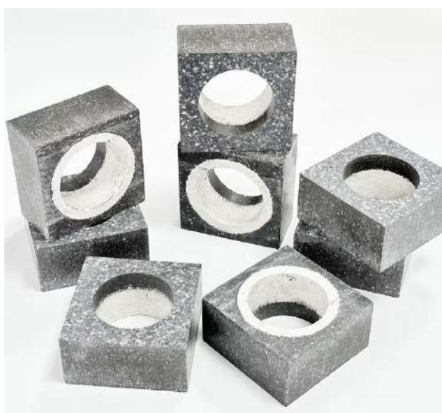
Рис. 4.4 – Контейнер из пиррофиллита для спекания композитов на основе cBN
