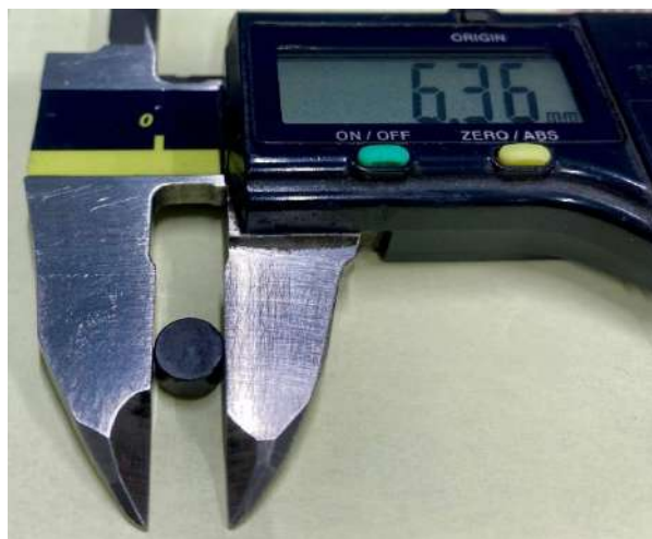
Рис. 5.18 – Режущее изделие на основе cBN, изготовленное для «тестовых» испытаний исследуемых составов
