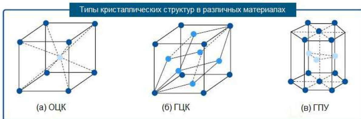
Рис. 1.4 – Распределение атомов в различных материалах [15]
